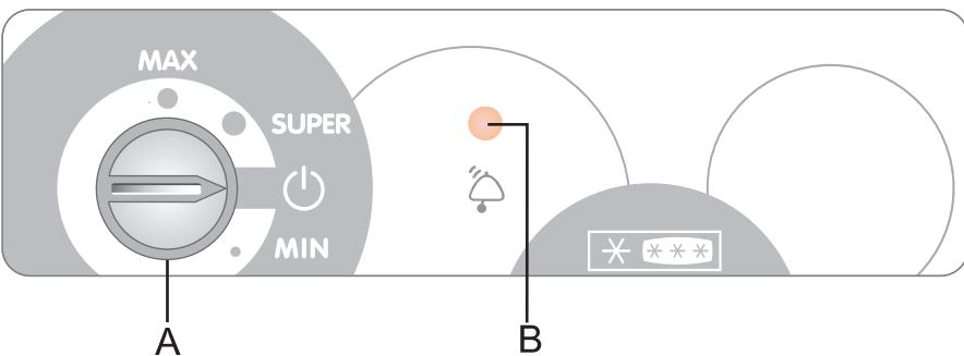
**А Переключатель вкл./выкл., установки температуры и SF/\***
